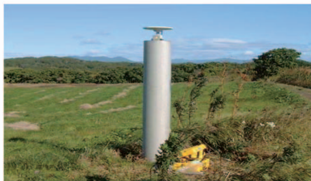
写真－2 地殻変動観測点「浦河5」。GPSアンテナの設置誤差を抑えるため、ピラーを設置している。
