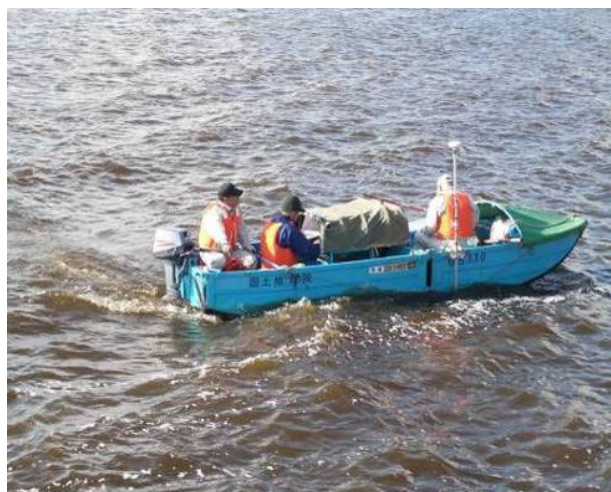
写真-5 音響測深機を用いた測深調査
