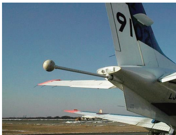
写真－4 「くにかぜⅡ」のプロトン磁力計センサー
