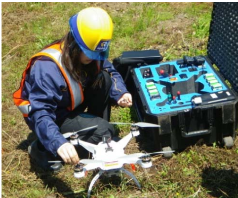
起工測量のUAV
