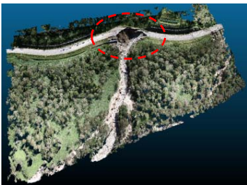
台風10号により被災しUAVによる三次元点群測量を実施した国道274号日勝峠
