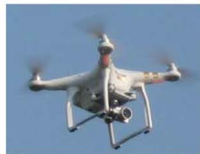
UAV(ドローン等)による3次元測量
