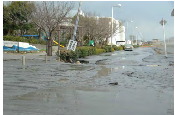
噴砂(東北地方太平洋沖地震)(出典: 浦安市)
