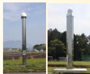
設置年により形状が 違う電子基準点
