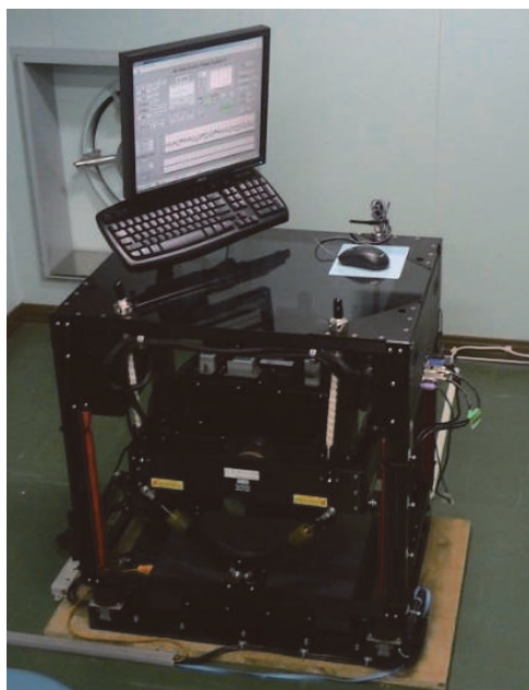
写真-6 Air-Sea II 相対重力計 (Micro-g Lacoste 社製、国立極地研究所所有)
