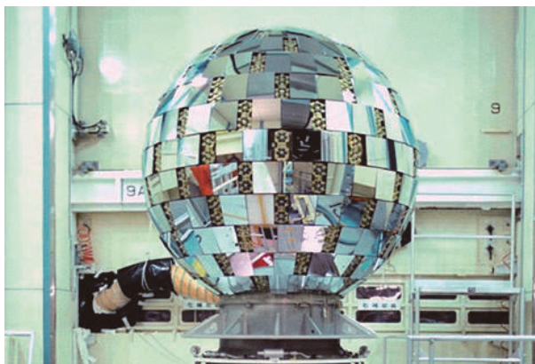
写真-5 測地実験衛星「あじさい」(EGS, JAXA の HP http://global.jaxa.jp/projects/sat/egs/index.html )
