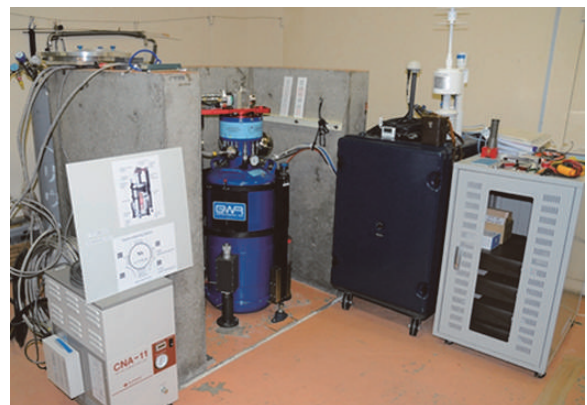
写真-3 OSG 超伝導重力計（GWR instruments 社製、南極昭和基地設置（Aoyama et al, 2015））
