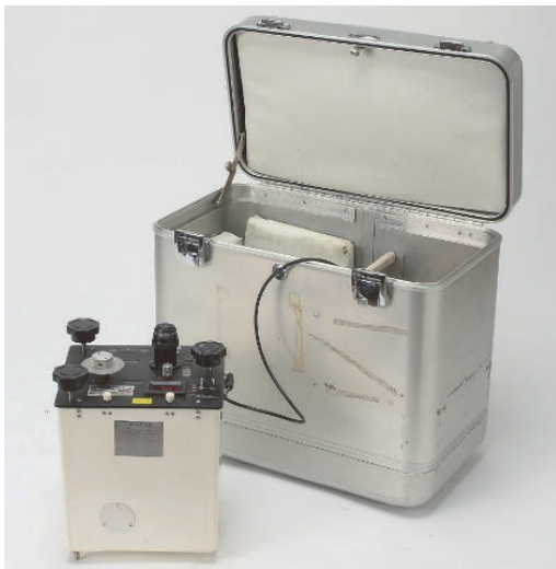
写真-2 ラコスト G 型重力計（2013 年 6 月 15 日撮影）
