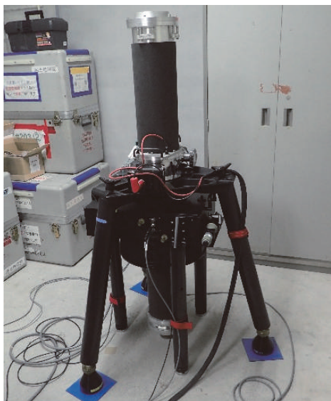
写真-1 FG5 絶対重力計（Micro-g Lacoste 社製、国土地理院所有#203）
