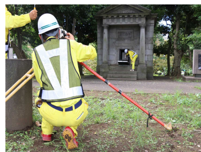
日本水準原点での水準測量
