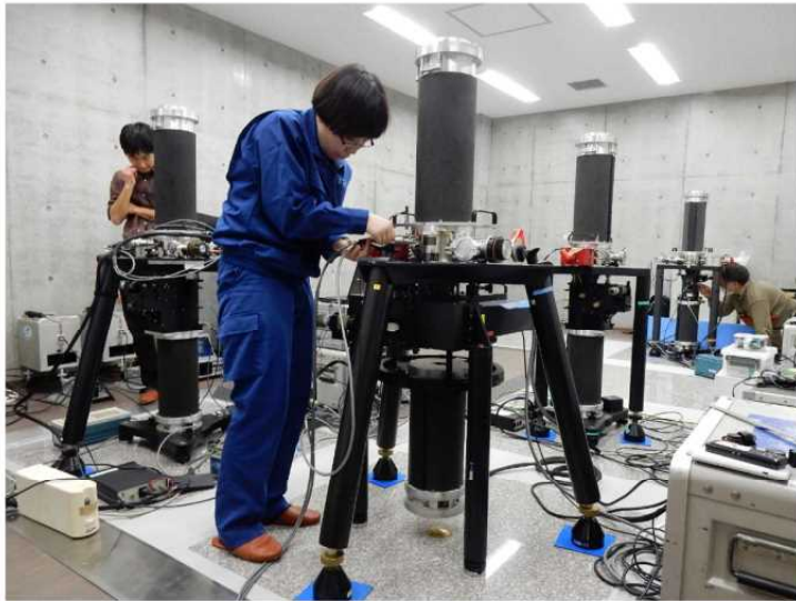
絶対重力測定（FG5絶対重力計）
